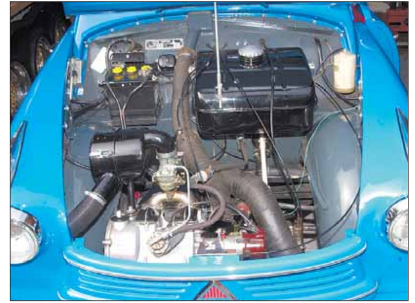
Der Motorraum des kleinen Lloyd Alexander; das Antriebsaggregat ist übrigens unten links, oben rechts sitzt der Benzintank.
